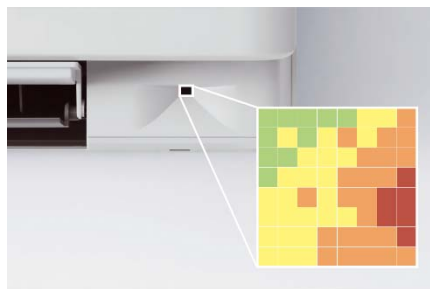
Mrežni senzor „inteligentno oko” meri površinsku temperaturu prostorije tako što je deli u mrežu sa 64 kvadranta.
